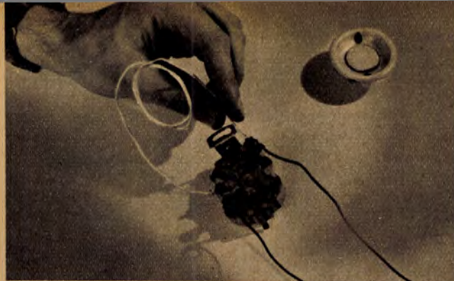
A nyomógomb két csavarjának áthidalása. Ezen a módon állapítható meg, hogy a nyomógomb hibás-e
